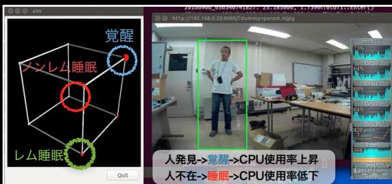
柔軟な知覚情報処理系を有するロボットを構築するために、人間の意識状態、特に睡眠/覚醒状態を数理モデルとして表現する研究を進めています。本モデルにより、覚醒時には外部(視覚や聴覚)情報を主に処理し、睡眠時には内部(記憶)情報を主に処理したり、処理を休止したりすることができます。動的な情報処理系が実現できます。限られた計算機資源の有効利用が可能となります。
