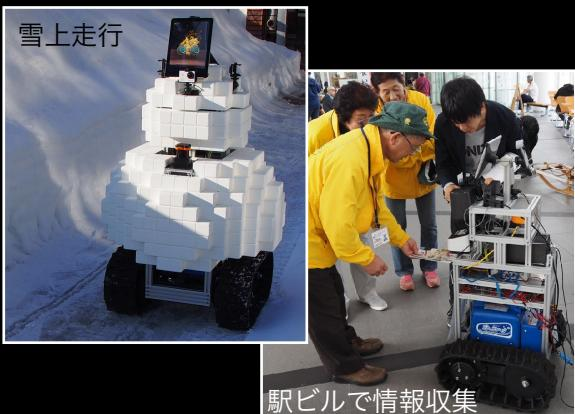
稚内北星学園大学と中部大学の共同研究で、積雪寒冷地の公共/商業エリアにおいて、観光者や地域住民に対して有益な情報を提供する移動ロボットシステムの研究を進めています。ロボットに搭載の多様なセンサに基づく環境認識、自己位置推定、ロボットの行動制御、人の行動予測機能等の要素技術、人とのコミュニケーション機能や情報提供機能等の少し高度な技術、それらを組み合わせた遠隔操作インターフェイスや全体のシステムを設計しつつ、簡便かつ安全なシステムの実現を目指します。
