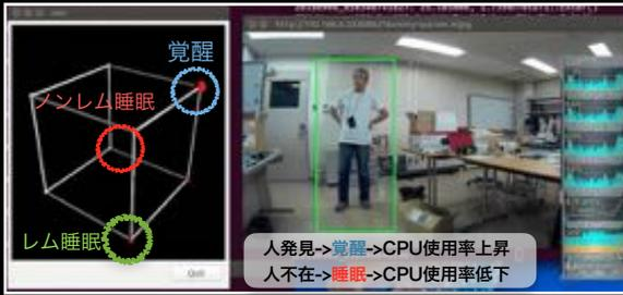
柔軟な知覚情報処理系を有するロボットを構築するために、人間の意識状態、特に睡眠/覚醒状態を数理モデルとして表現する研究を進めています。本モデルにより、覚醒時には外部(視覚や聴覚)情報を主に処理し、睡眠時には内部(記憶)情報を主に処理したり、処理を休止したりすることができる動的な情報処理系が実現できます。限られた計算機資源の有効利用が可能となります。
